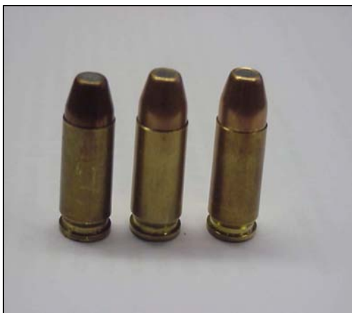
Cartuchos con longitud alterada por manipulaciones de carga y descarga.
