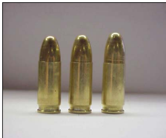
Cartuchos con longitud alterada por manipulaciones de carga y descarga.
